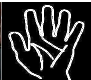
Figure 5: Sobel edge detection
